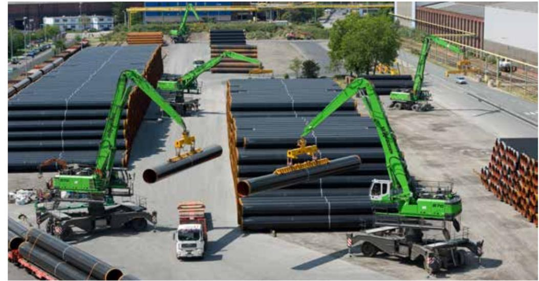
Lkw- und Bahnverladung von Großrohren. Foto: EUROPIPE GmbH
